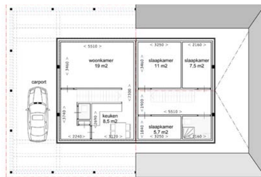
2 onder 1 kap, specifiek, begane grond en 1e verdieping
