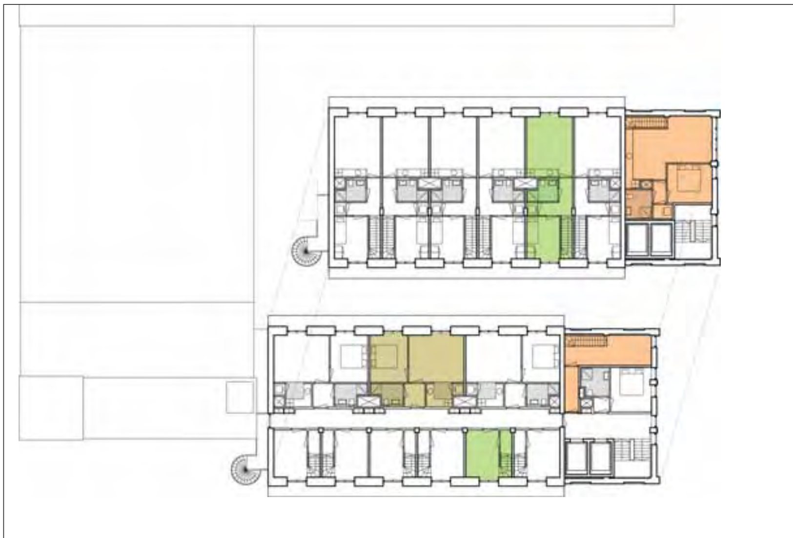
ACM complex Groningen, nieuwe verdiepingvloeren voor studentenwoningen
