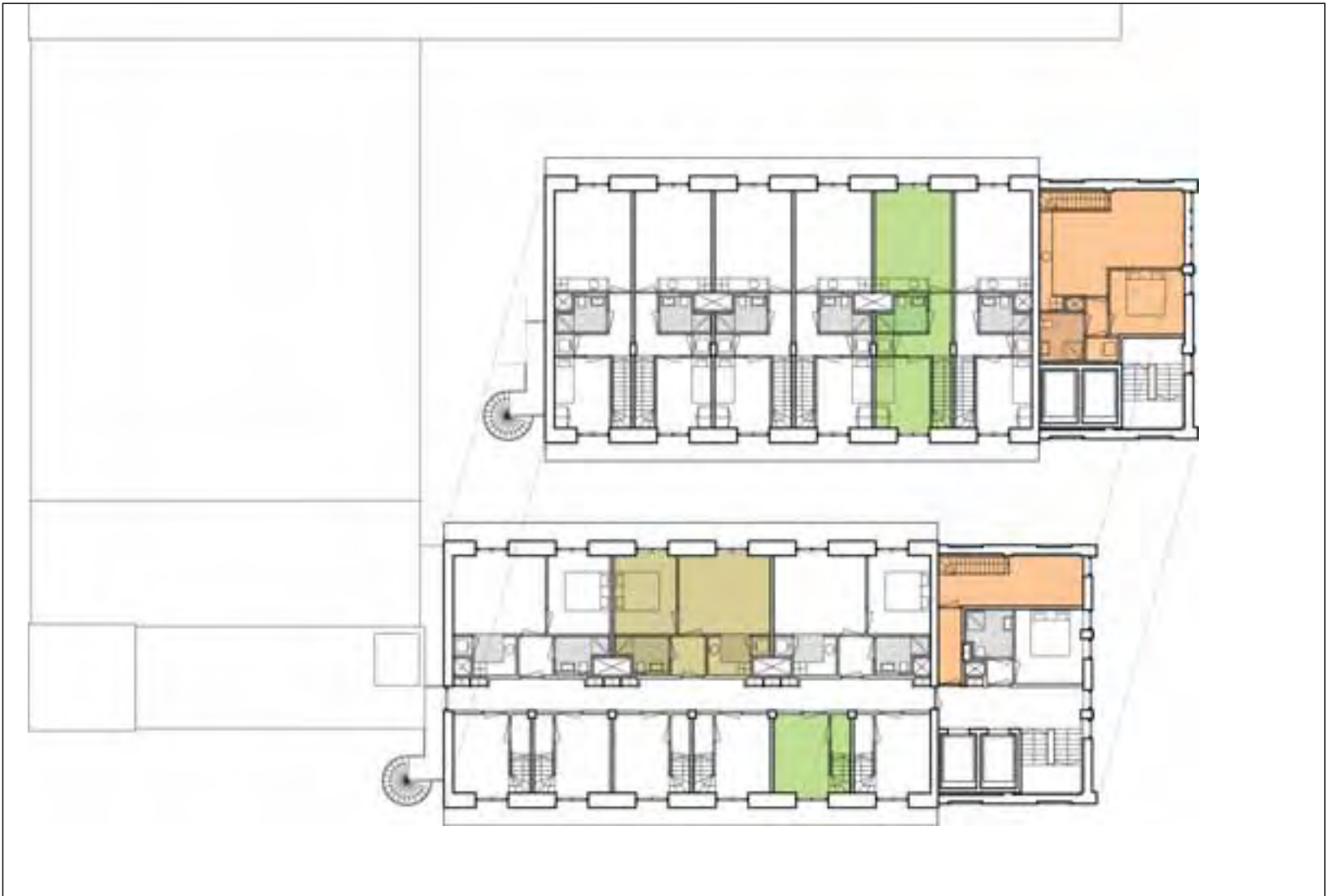
ACM complex Groningen, nieuwe verdiepingsvloeren voor studentenwoningen
