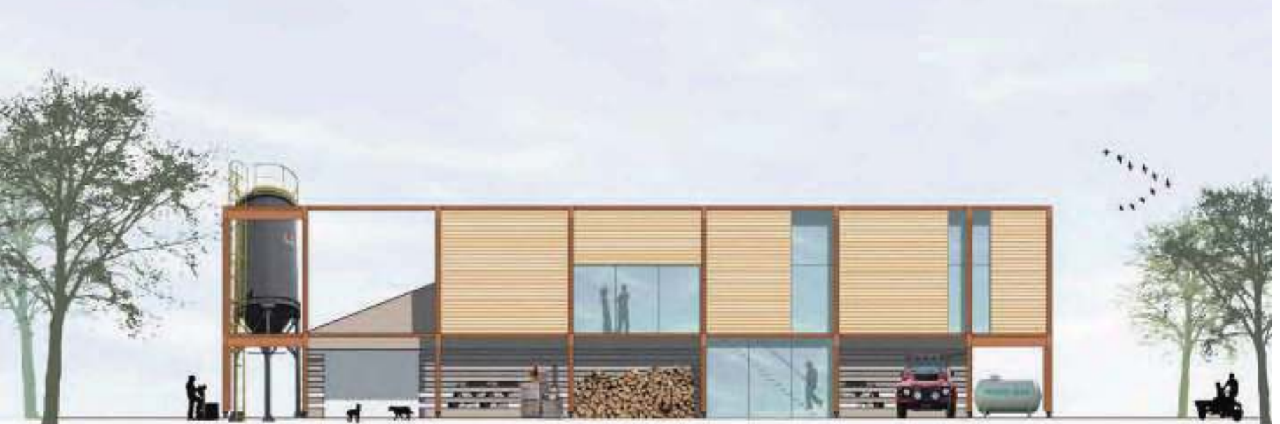
Impressie van het dubbele schil principe met verschillende gevelinvullingen
